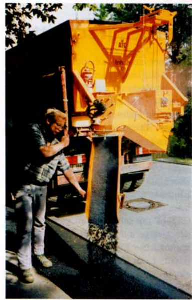
Gut verteilt: Mit ständig heißem Mischgut vermeidet man Einbauprobleme oder Reklamationen und spart sich den Aufwand für unwirtschaftliche Teilladungen. Die zusätzliche externe Verteilerschnecke erreicht auch Stellen weit neben dem Fahrzeug.
