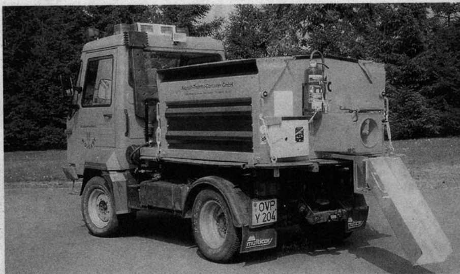
Jüngster Spross in der Familie der Asphalt-Thermo-Container: die Multicar-Version.
