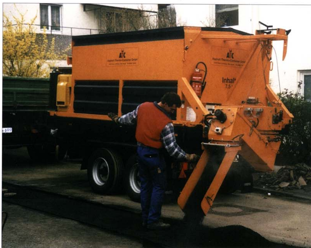
Eine hohe Flexibilität bietet das Tandemfahrwerk des „Asphalt-Thermo-Containers“ mit externer Förderschnecke. Der Container lässt sich damit unabhängig vom Zugfahrzeug auf der Baustelle betreiben.
